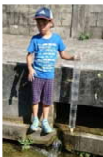
ペットボトルで作った透視度計
